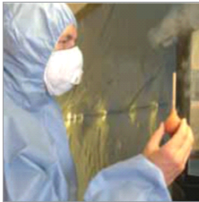
[그림 7-8] 발연관을 이용한 밀폐 적정유무 확인방법
