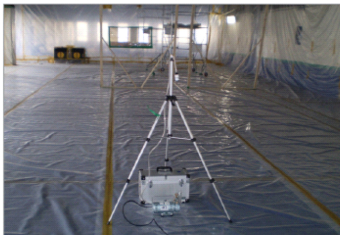
[그림 11-2] 석면농도 측정 모습
