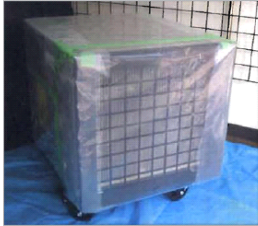
[그림 4-8] 이동 및 보관시 음압기 밀봉 예
