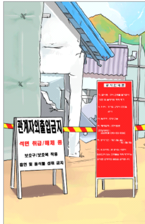
[그림 2-3] 석면해체·제거 작업장 바리케이드 및 경고표치 설치 예
