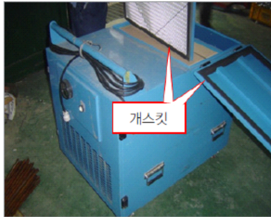
[그림 4-3] 공기누설 방지를 위한 개스킷 설치 예
