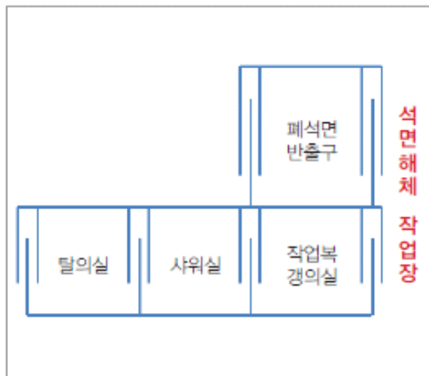
[그림 10-6] 석면폐기물 반출구 설치 도면 예시
